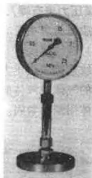
图 4-7 工字型法兰隔膜压力表 图 4-8 散热型法兰隔膜压力表 (3) 夹子连接
